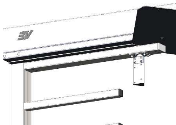
Рисунок 9.15 - Турникет с правильным положением верхнего подшипникового узла
