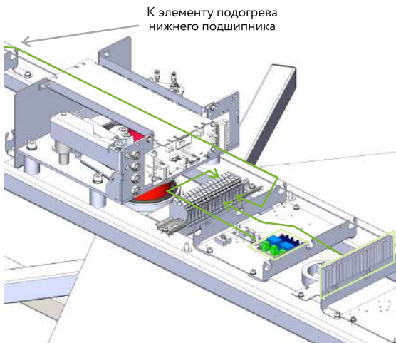
Рисунок 10.3 - Элементы подогрева в корпусе механизма
