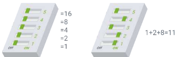
Рисунок 7.1 - Адресация платы модуля доступа
