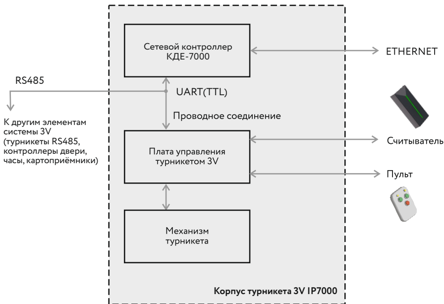
Структура турникета IP7000 (нагреватель и узел питания не показаны)
